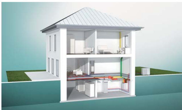
Funkčná schéma zapojenia: Centrálna rekuperačná jednotka recoVAIR a tepelné čerpadlo aroTHERM vzduch/voda s modulom uniTOWER značky Vaillant
